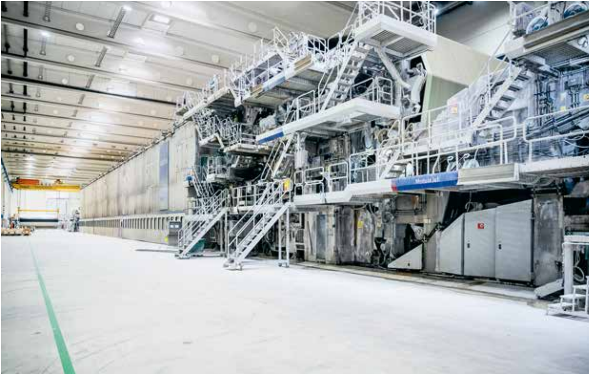
Die Papiermaschine in Perlen ist 200 Meter lang und 10 Meter hoch und produziert Zeitungspapier.
